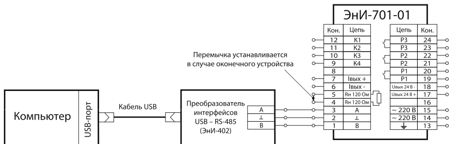
Рисунок Б.8 — Схема подключения регистратора с интерфейсом RS-485 к компьютеру
