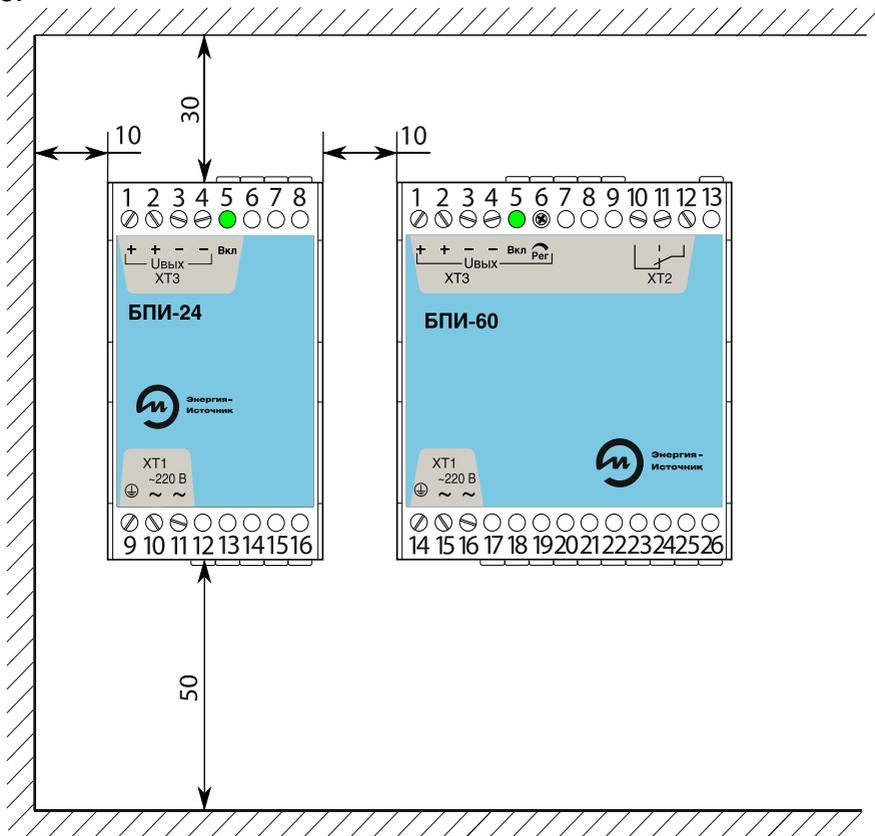
Рисунок 2 — Минимальные зазоры для блоков БПИ-24, БПИ-30, БПИ-60
