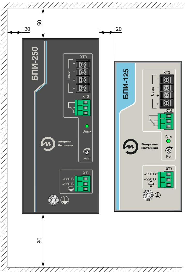
Рисунок 3 — Минимальные зазоры для блоков БПИ-125, БПИ-250
