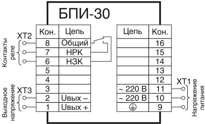
Рисунок Б.1 — Схема подключения блоков БПИ-30
