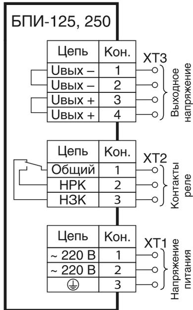
Рисунок Б.4 — Схема подключения блоков БПИ-125, БПИ-250
