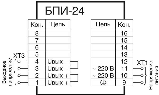
Рисунок Б.3 — Схема подключения блоков БПИ-24
