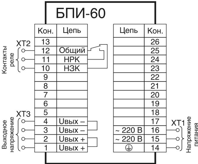
Рисунок Б.2 — Схема подключения блоков БПИ-60
