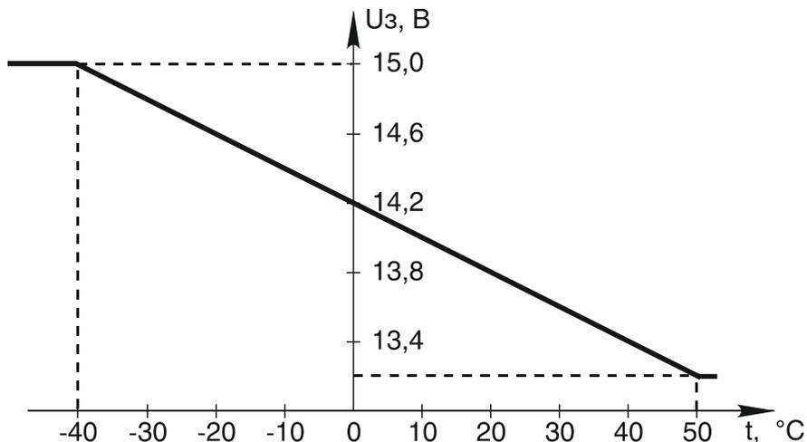
Рисунок 1 — Зависимость напряжения заряда АКБ от температуры
