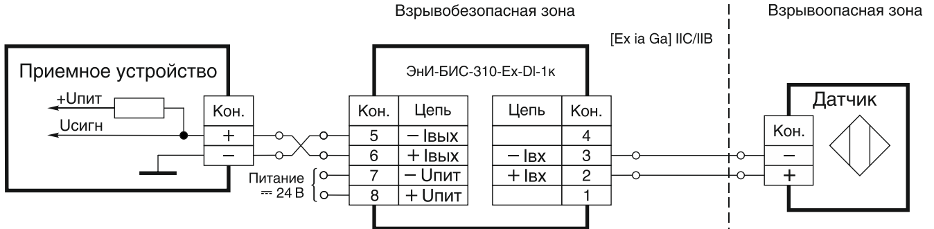
Рисунок Б.2 — Схема подключения барьера ЭНИ-БИС-310-Ex-DI-1к к датчику с выходным сигналом по стандарту NAMUR
