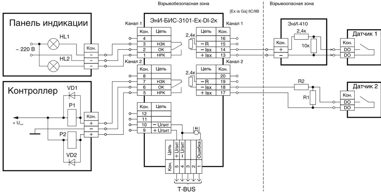
Датчик 1 — датчик с выходом типа «сухой контакт» (с реализацией контроля цепи при помощи модуля резисторов NAMUR ЭНИ-410);
