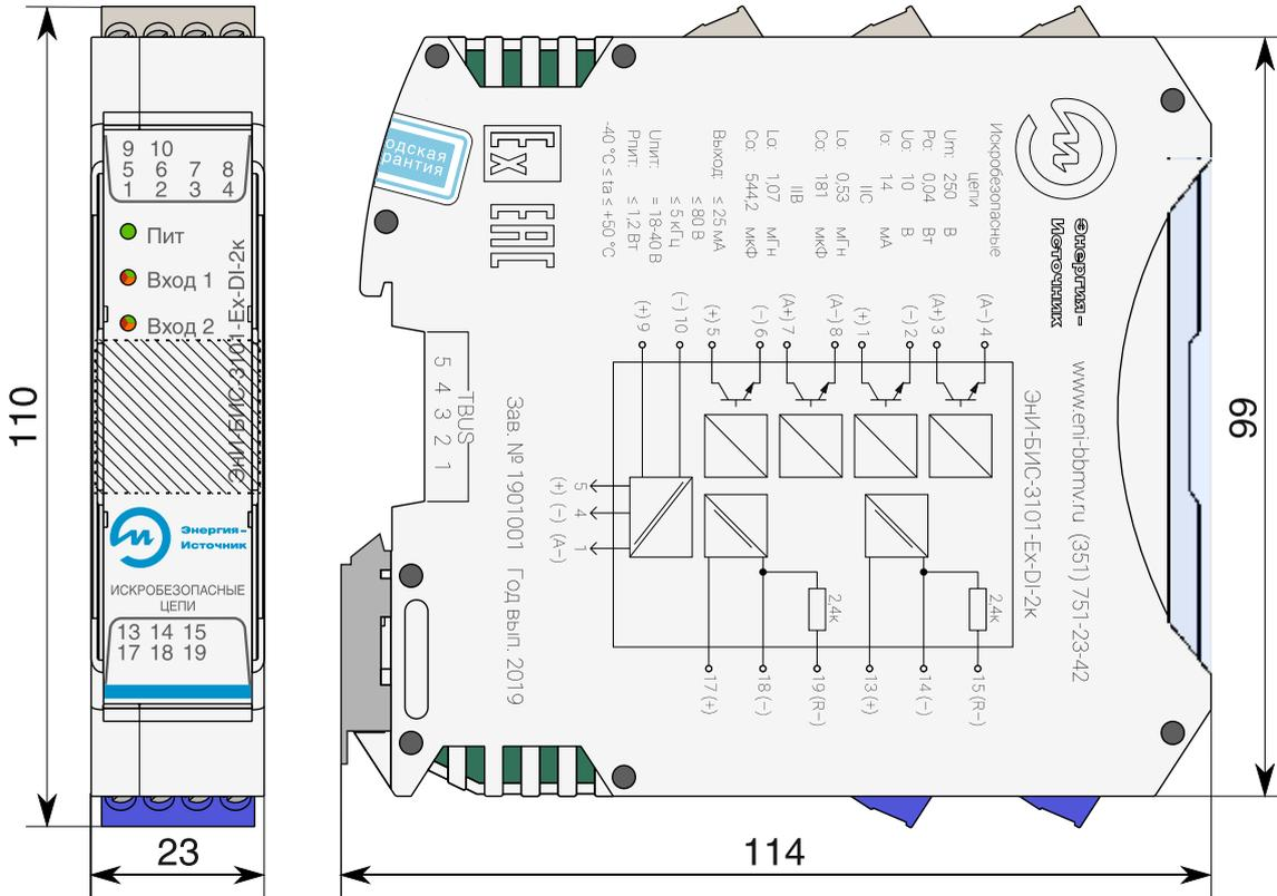
Рисунок А.3 — Габаритные размеры барьера с разъемами с винтовыми клеммниками
