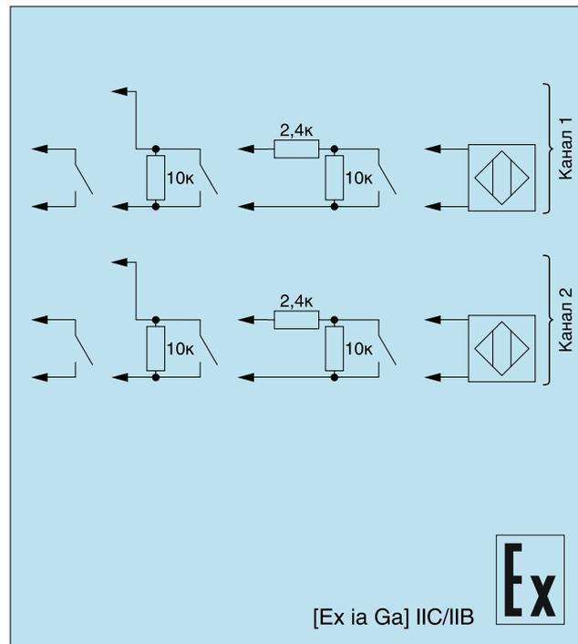
Рисунок 9 — Упрощенная функциональная схема Эни-БИС-3101-Ex-DI-2к-В(НРК)-В(2)
