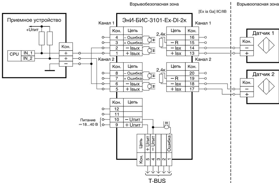
Датчик 1, 2 — датчик с выходным сигналом по стандарту NAMUR.
