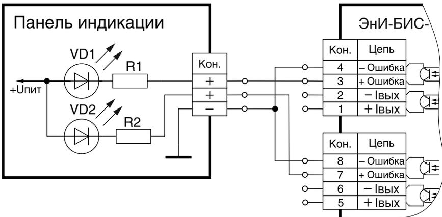
Рисунок Б.5 — Схема подключения выходов «Ошибка» к светодиодной индикации
