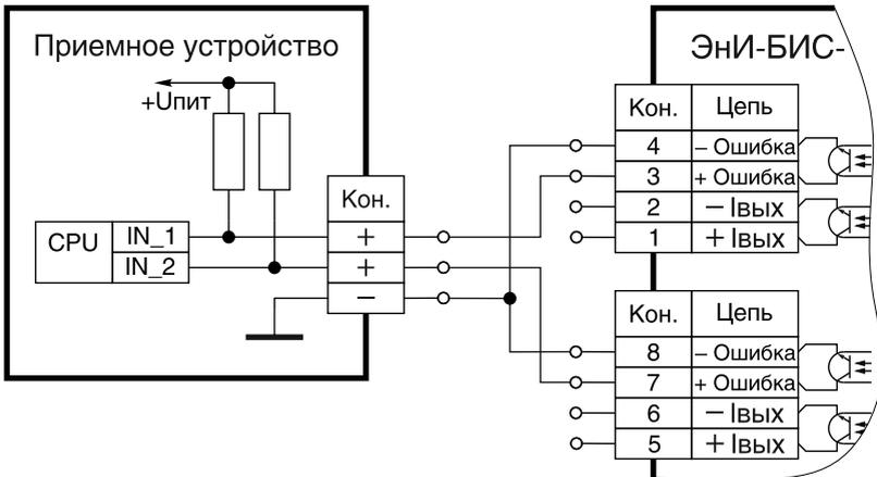
Рисунок Б.4 — Схема подключения выходов «Ошибка» к контроллеру
