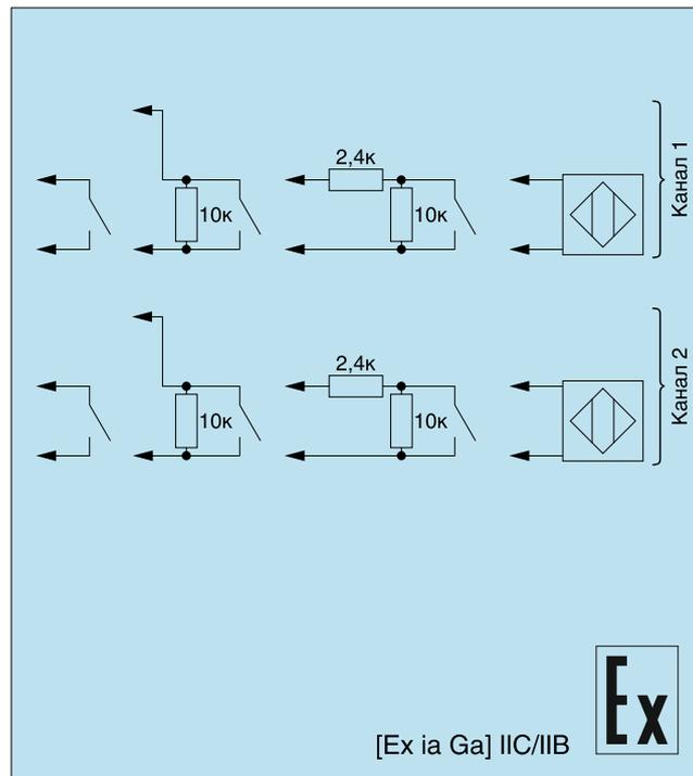
Рисунок 8 — Упрощенная функциональная схема Эни-БИС-3101-Ex-DI-2к-В(НРК)-В(НРК)
