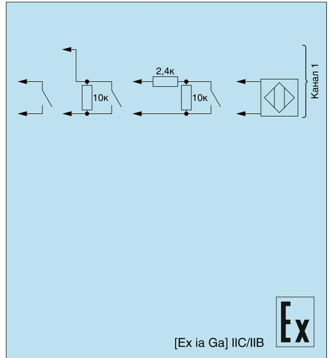
Рисунок 11 — Упрощенная функциональная схема ЭНИ-БИС-3101-Ex-DI-1к-Г-Г
