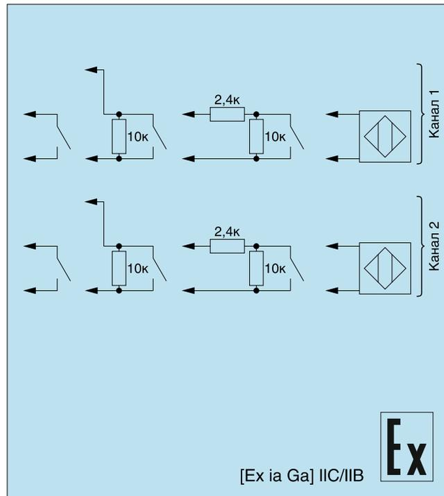
Рисунок 10 — Упрощенная функциональная схема ЭНИ-БИС-3101-Ex-DI-2к-Г
