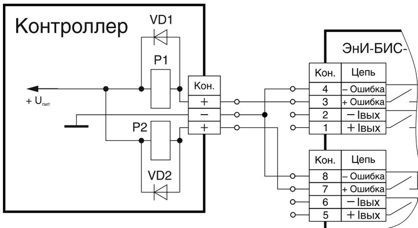
Рисунок Б.6 — Схема подключения выходов «Ошибка» к контроллеру
