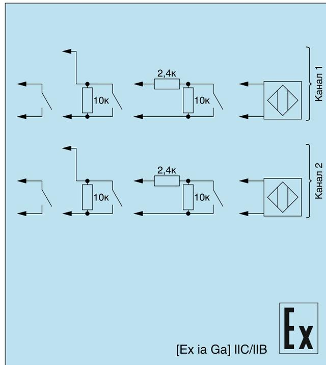
Рисунок 7 — Упрощенная функциональная схема ЭНИ-БИС-3101-Ex-DI-2к-А-Б
