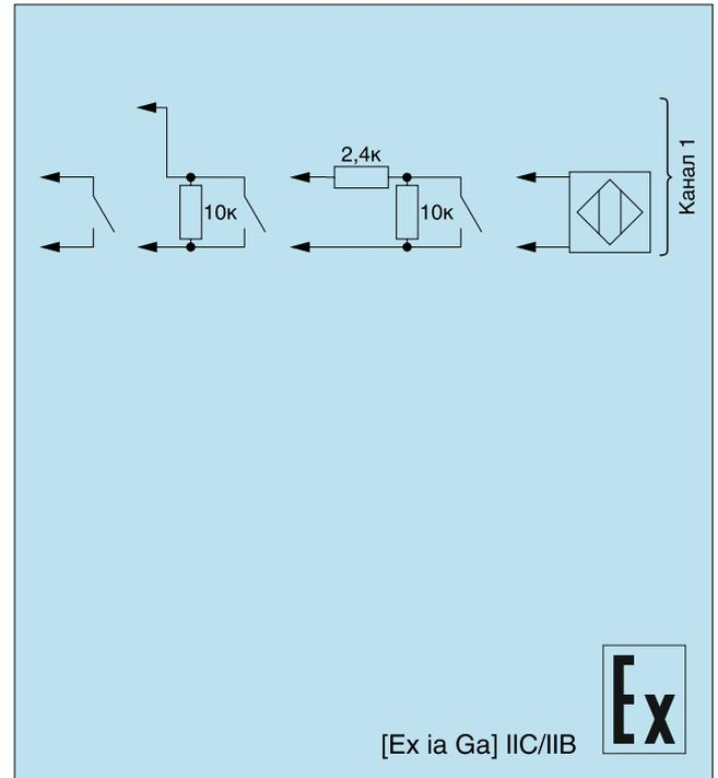
Рисунок 12 — Упрощенная функциональная схема ЭНИ-БИС-3101-Ex-DI-1к-Г-Г(2)
