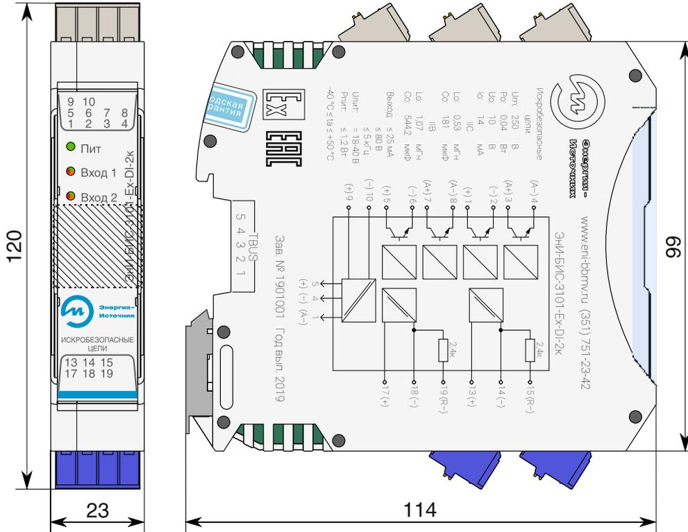
Рисунок А.4 — Габаритные размеры барьера с разъемами с пружинными клеммниками и тестовыми гнездами
